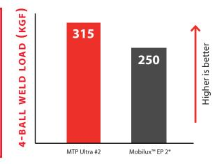
\*Hydrotex<sup>®</sup> lab test result 2016
